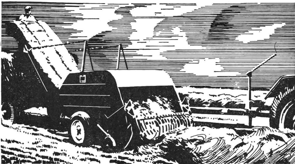
Niederdruck-Presse F-5-91 mit Zapfwellenantrieb
