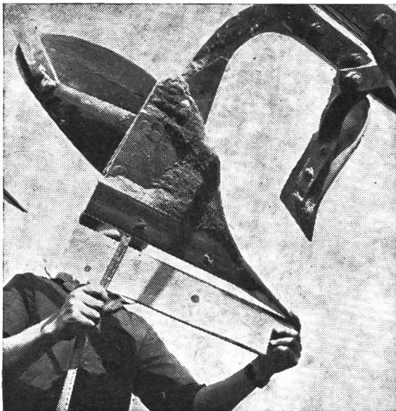
Mit Hilfe einer Latte und des Zollstocks kann man leicht feststellen, ob der Pflug noch genügend «Untergriff» hat.
