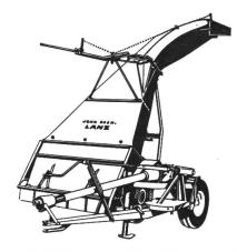
Hochdruck-Sammelpresse 214 B/D für Heu und Stroh. Aufnahmebreite 1,60 m, Stundenleistungen: Stroh 7 Tonnen, Heu 9 Tonnen.
