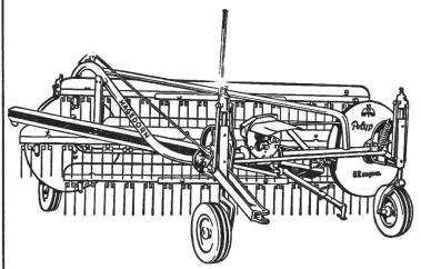
Auflockern des frischen Schwads durch «Anlüften» oder «Zetten» schon beim Mähen, Schwadrechen, Schwadwenden und Schwadstreuen, Breitwenden und Einfach- oder Mehrfachschwadziehen. Der Schubrechwender «Polyp» macht Handarbeit und Zusatzgeräte praktisch überflüssig. Er ist aber nicht nur in der Heuernte einsetzbar, auf manch anderen Gebieten leistet er nützliche Hilfe.
