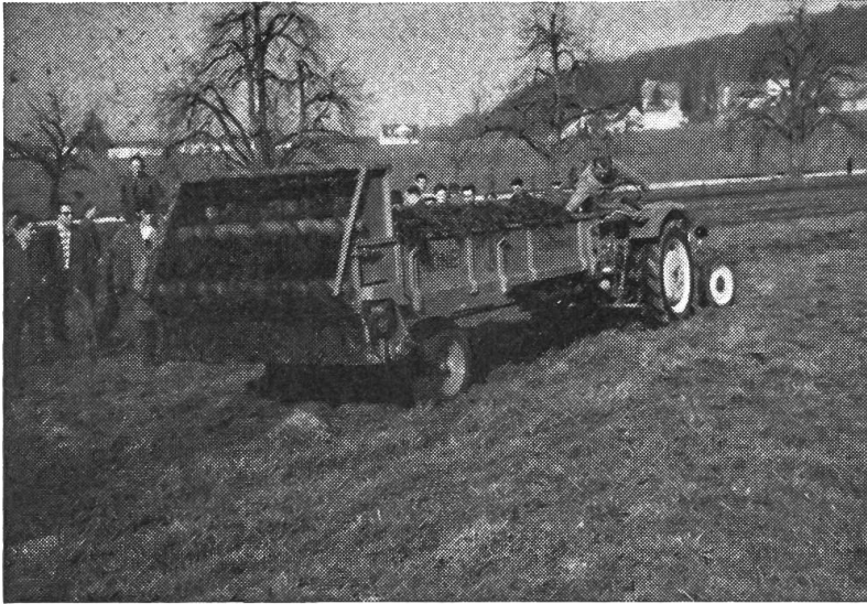
Abb. 1: Heckstreuer mit zwei liegenden Walzen
