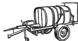
Bimoto-ARBOR-Zapfwellenwagen in Aktion Bimoto-TITAN-BH-III 75 l/min - 60 Atm. - 1000 Liter Holzfass - Pneus 9.00-13'' - Podest - Schraubstütze - Vertikal-Spritzbarren für Hecken- und Busch-Anlagen
