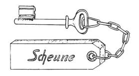
Werden soiche Schlüssel mit einem Stück: Holz, das mindestens 2 x 4 x 12 cm gross sein sollte, durch eine leichte Kette zu einem Gehänge verbunden (siehe Bild), dann mag sie niemand in die Tasche stekken. Sie werden deshalb lieber an das Schlüsselbrett zurückgebracht als sonst. Sollte aber so ein Gehänge doch einmal verlegt werden, ist es auf alle Fälle wieder leichter aufzufinden.
