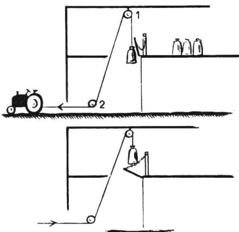
Drahtseil aufgehängt, das über die beiden Scheiben 1 und 2 geführt ist, und bis zur Gebäudeaussentwand reicht. Dort wird es an den Traktor angehängt und von diesem gezogen. Der am andern Ende mittels einer Kette an einem Haken oder einem Ring befestigte Sack wird, wenn möglich, einer Wand entlang hochgezogen. Den Boden jedes Stockwerkes kann er durch eine Falltür passieren. Draussen auf dem Boden entsprechend gekennzeichnete Stel-
