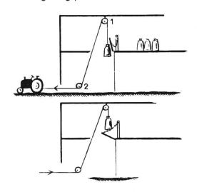
Drahtseil aufgehängt, das über die beiden Scheiben 1 und 2 geführt ist, und bis zur Gebäudeaussenwand reicht. Dort wird es an den Traktor angehängt und von diesem gezogen. Der am andern Ende mittels einer Kette an einem Haken oder einem Ring befestigte Sack wird, wenn möglich, einer Wand entlang hochgezogen. Den Boden jedes Stockwerkes kann er durch eine Falltüre passieren. Draussen auf dem Boden entsprechend gekennzeichnete Stel-
