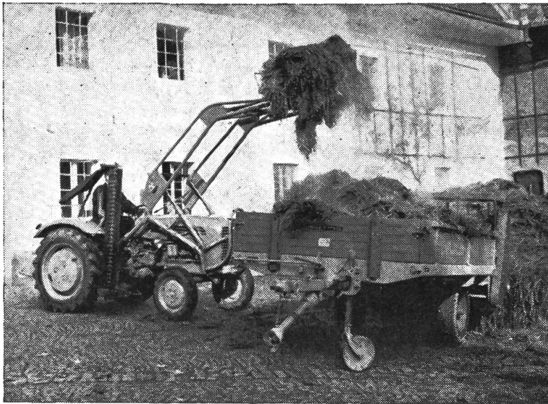
Der Frontlader beim Mistladen, hier mit Mistgabel. Für stroharmen Mist ist die Erdschaufel besser geeignet, während strohiger Mist wegen des grösseren Fassungsvermögens günstiger mit den Federstahlmehrzweckgabeln geladen wird.
