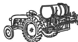
Bimoto-Sattel-Aufbau in Aktion Bimoto-DUAL-Hochdruck-Zweikolbenpumpe Druckentlastungsventil 40 l/min - 50 Atm. - Kardanwelle mit 2 Kreuzgelenken - Spritzbarren 11reihig mit Fanjet-Fächerbrausen
