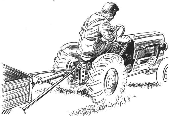
Sichere Fahrt mit dem beschriebenen Aggregat Tetrax 303 zur hydromechanischen Betätigung irgend einer Anhängerbremse. Der Anhänger wird vom Führersitz aus mühelos und zuverlässig gebremst.
