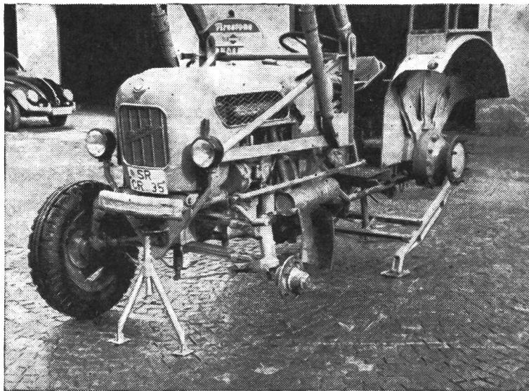
Vorn und hinten mit dem Hebebock aufgebockter Traktor.
