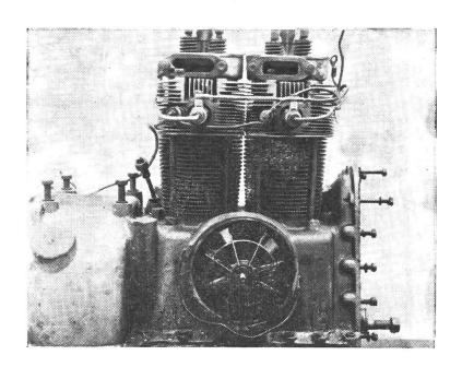
So sollte der luftgekühlte Motor stets aussehen. Mit etwas Mühe ist das möglich. meln kann, wenn er nicht von Zeit zu Zeit vom Traktorfahrer entfernt wird. Wenn man sich einen harten Pinsel besorgt, kann vor allem in der Haupteinsatzzeit des Traktors der luftgekühlte Motor mit wenigen Handgriffen gereinigt werden.
