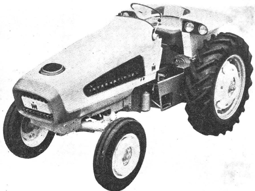
Die Gasturbine des Traktors leistet 80 PS und ist ein Erzeugnis der Solar Aircraft Company, einer Tochtergesellschaft der International Harvester. Sie war ursprünglich für den Antrieb von Hubschraubern vorgesehen und ist eine der kleinsten Turbinen, die je für diese Zwecke gebaut worden sind.
