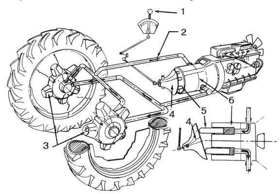
Schema der stufenlosen Kraftübertragung des hydrostatischen Getriebes beim Versuchstraktor International HT-340. Das neue Kraftübertragungs-System setzt sich aus 3 Hauptelementen zusammen: eine durch den Motor angetriebene Pumpe und zwei in den Antriebsrädern untergetrachte Pumpen (Hydraulikmotoren).
