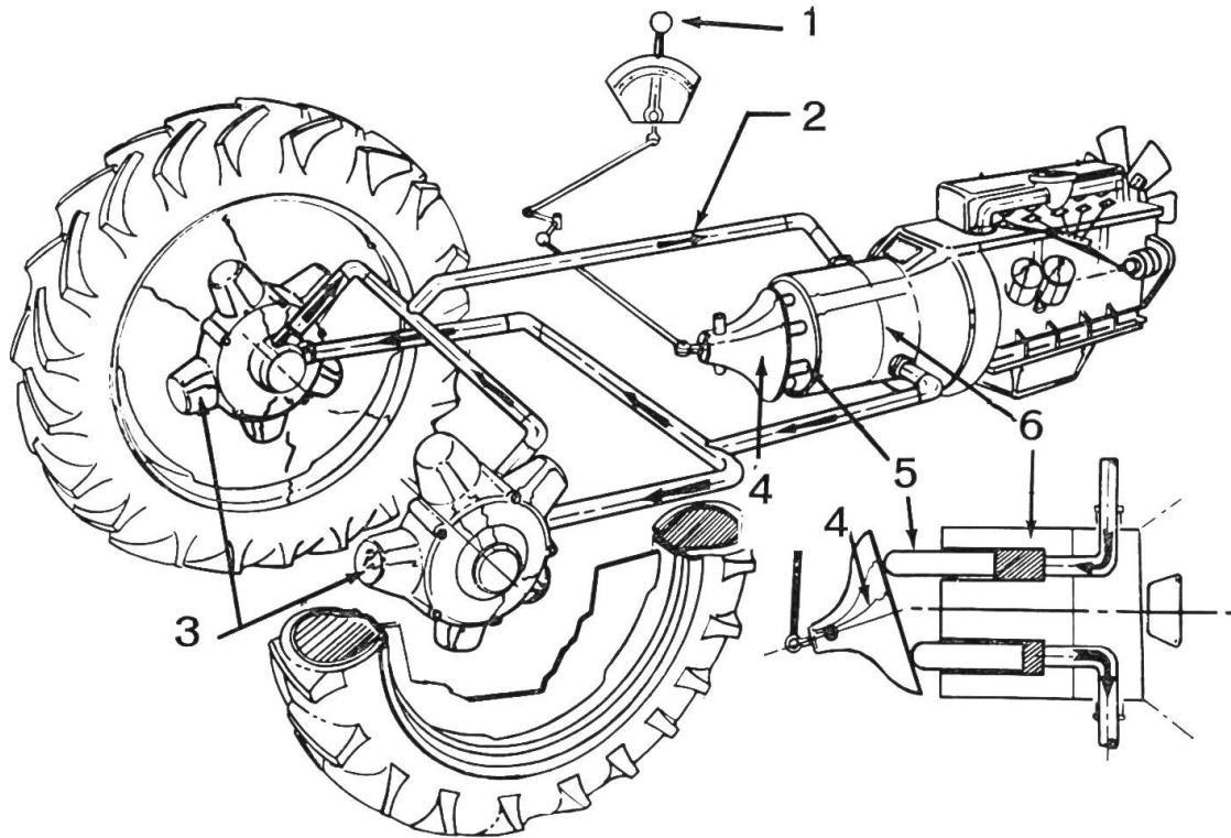
Schema der stufenlosen Kraftübertragung des hydrostatischen Getriebes beim Versuchstraktor International HT-340. Das neue Kraftübertragungs-System setzt sich aus 3 Hauptelementen zusammen: eine durch den Motor angetriebene Pumpe und zwei in den Antriebsrädern untergetragte Pumpen (Hydraulikmotoren).
