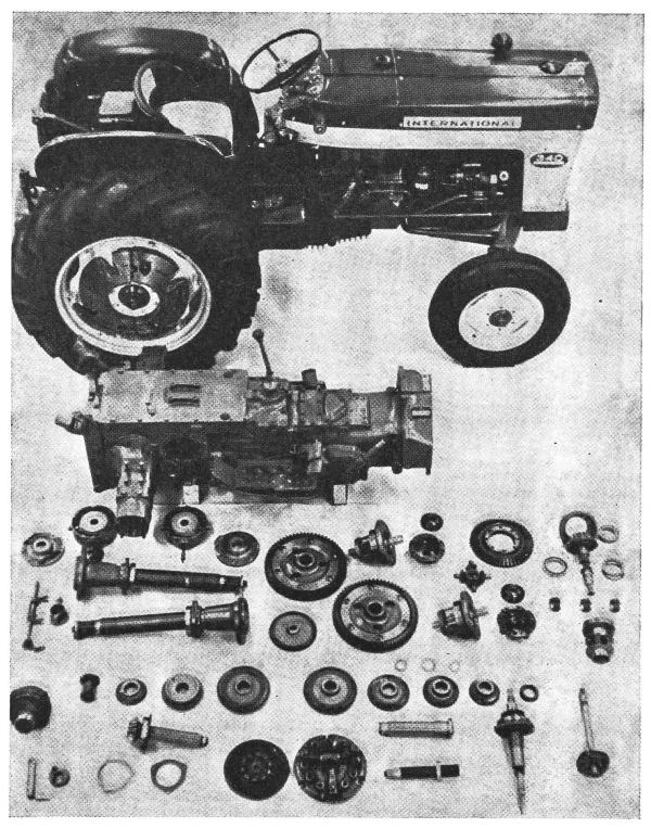
Das stufenlose hydrostatische Getriebe des Versuchstraktors International HT - 340 wurde auch in einen regulären Serientraktor mit 40 PS Kolbenmotor eingebaut. Unser Bild zeigt vor dem Traktor ausgebreitet sämtliche Organe und Bestandteile, die die Anwendung des hydrostatischen Getriebes überflüssig machte.
