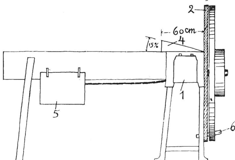
**Futterschneider für Handbetrieb soll man nicht auf motorischen Antrieb umstellen,** weil die nötigen Sicherheits- und Schutzvorrichtungen, wie z. B. Getriebeausräcker, Schutzkasten über dem Messerschwungrad und Getriebe u. a. m., fehlen und Schwungradbruch möglich ist.
