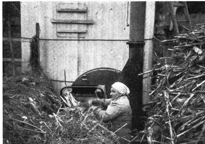
Wenn an der hintern Umlenkrolle der Förderkette die Schutzvorrichtung fehlt, empfiehlt es sich, Seitenladen anzubringen (vergleiche Abb. 2 «Futterschneider»).
