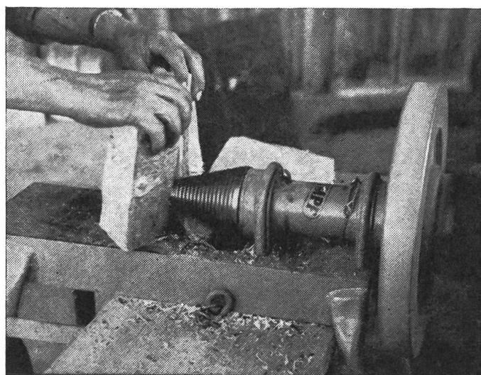
Die Holzspaltmaschine muss stabil aufgestellt werden. Der Antriebsriemen darf den Arbeitenden in keiner Weise hindern. Die Klötze flach auf den Arbeitstisch auflegen und das Holz **hochkant** gegen den Bohrer stemmen. Den Klotz **oben** anfassen, nicht auf Bohrerhöhe oder gar unten.
