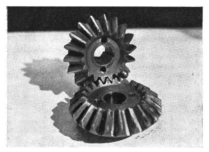
Angebrochene Zähne als Folge der aus einem Kugellager ausgetretenen Stahlkugeln, die mit dem aufwärts beförderten Getriebeöl zwischen die Zahnung der Kegelräder «geschwemmt» werden.
