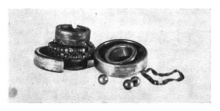
So sehen die Kugellager nach kurzer Zeit aus, sobald mit stumpfen, abgenützten Streuelementen gefahren wird. Hier ist «Hopfen und Malz» verloren. Da hilft nur noch Ersatz, verbunden mit einem tiefen Griff in den Geldbeutel,
