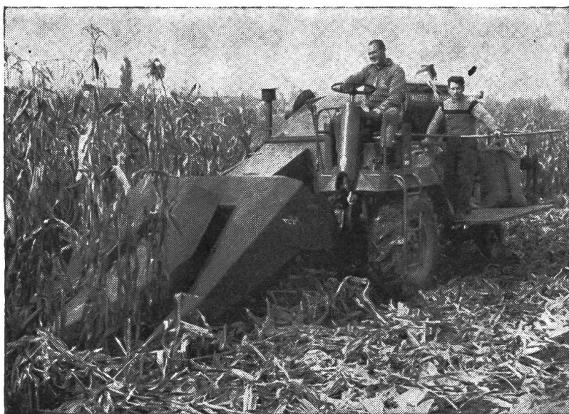
Mähdrescher umgebaut zum Pflücken der Maiskolben
