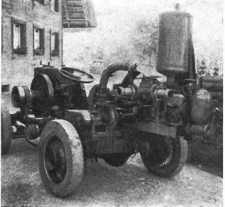
Abb. 6: Fahrzeug für Lohngüllerei, mit Zentrifugal- und Kolbenpumpe (System Walter, Riggisberg).
