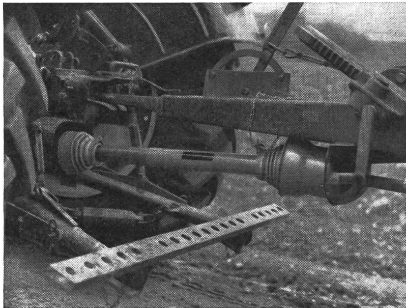
Abb. 9: Vollgeschützte Gelenk- welle (W-Schutztopf am Gerät).
