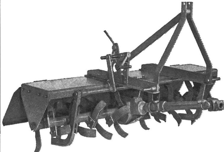
Lieferbar in verschiedenen Arbeitsbreiten von 1,5 bis 2,2 m auswechselbare Arbeitswalzen mit verschiedenen Messerzahlen. Für 3- und 1-Punkt-Hydraulik oder mit hydraulischem Handaufzug. Modernste Tiefenregulierung mit Bügel oder Stützrädern, welche bequem vom Führersitz aus eingestellt werden kann.
