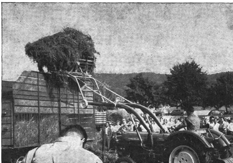
Abb. 4: Frontlader mit Ladeschwinge. Das Verfahren fordert vom Bedienungsmann Routine.
