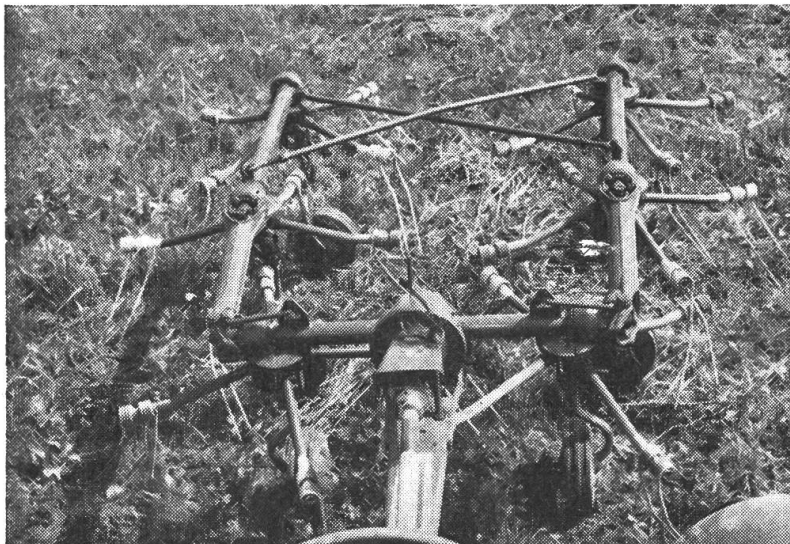
Abb. 9: Kreiselheuer Fahr KH 6 in Transportstellung. Man erkennt deutlich die 6 Glieder mit je 4 kreuz- weise angeordneten zwei- zinkigen Gabeln.
