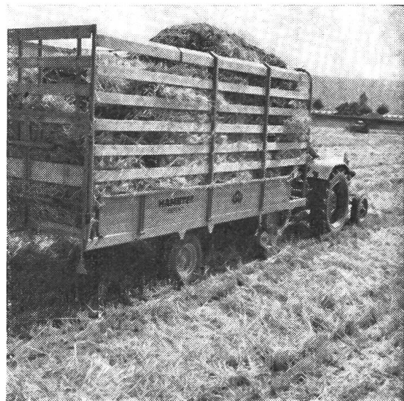
Abb. 12: Hamster-Sammelwagen mit Untenbeschickung. Das Futter wird in den Laderaum gepresst.
