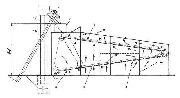
Abb. 14: Schnitt durch einen Durchlauftrockner. Das zu trocknende Gut wandert von Punkt A zu Punkt C, wo vor der Umlenkrolle eine Fallstufe angebracht ist. Von dort wird das Gut durch eine Förderkette auf der unteren schiefen Ebene bis zu Punkt F gefördert. Durch die Anordnung von zwei schiefen Ebenen übereinander kann eine sehr lange Trocknungszone erreicht werden.
