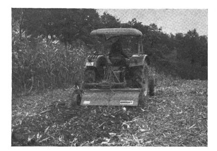
Abb. 12: Verarbeiten des Maisstrohes mit zapfwellengetriebener Spatenegge.
