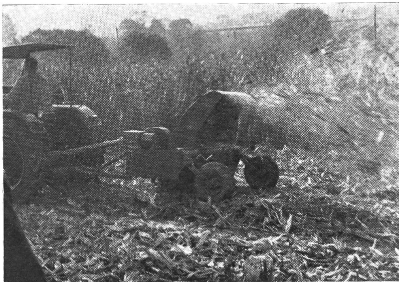
Abb. 11: Schlegelfeld- häcksler beim Zerschlagen des Maisstrohes.
