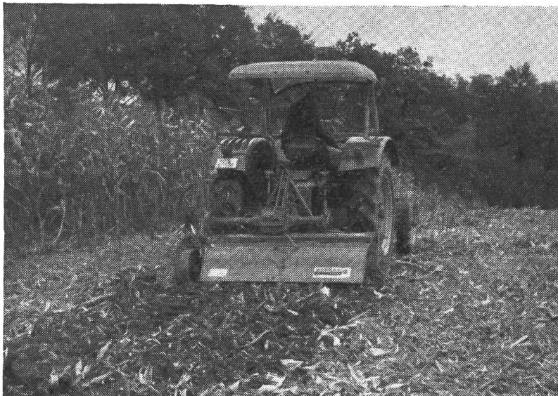
Abb. 12: Verarbeiten des Maisstrohes mit zapfwellengetriebener Spatenegge.
