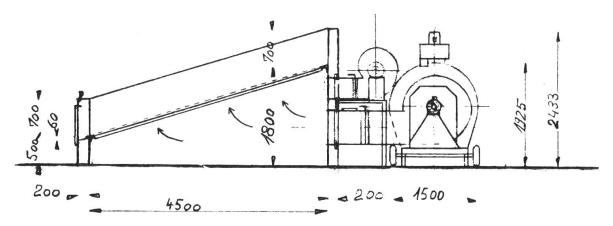
Abb. 13: Der Siebboden des Satztrockners ist schief gestellt. Die Luft wird von unten nach oben durch eine ca. 50 cm hohe Körnerschicht gepresst. Auf der rechten Seite des Bildes sieht man den Heizofen mit Ventilator und darauf einen zweiten Ventilator aufgebaut, mit welchem nach der Trocknung frische Aussenluft zum Abkühlen des Trockengutes gefördert wird.
