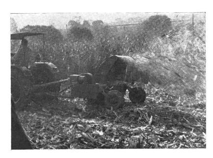
Abb. 11: Schlegelfeldhäcksler beim Zerschlagen des Maisstrohes.
