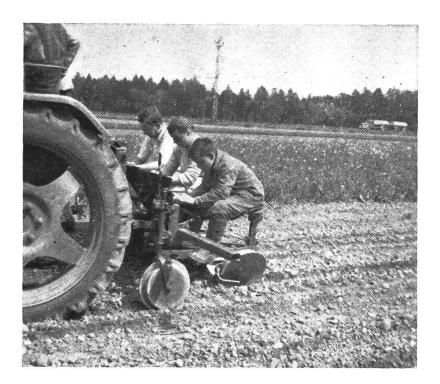
Abb. 2: Einzelkornsäapparate. Die Körner werden durch ein schräg angebrachtes Zellenrad ausgestossen.
