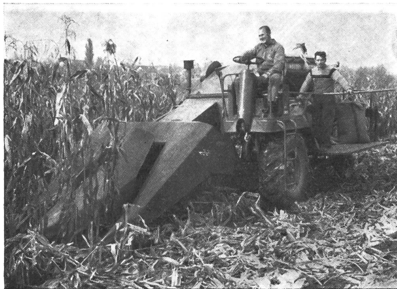
Abb. 10: Vorne am Mäh- drescher ist eine Pflück- vorrichtung, welche die Kolben abpflückt.
