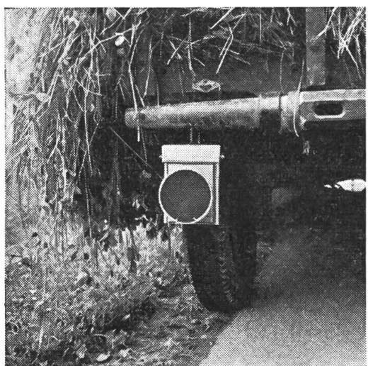
Abb. 16–19: Möglichkeiten, die zeigen, wie man landw. Anhänger hinten links vorschriftsgemäss mit einem Schlusslicht ausrüsten kann.
