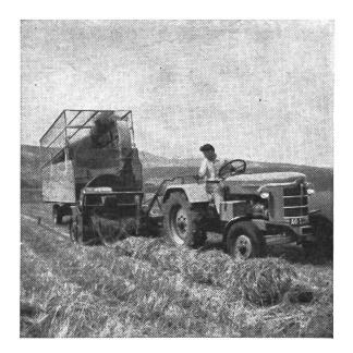
Abb. 7: Scheibenradfeldhäcksler und Häckselwagen mit Drahtgeflechtaufsatz für Heu
