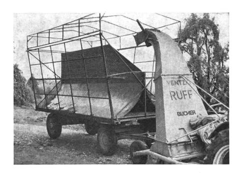
Abb. 12: Häckselwagen mit Trennkeil
