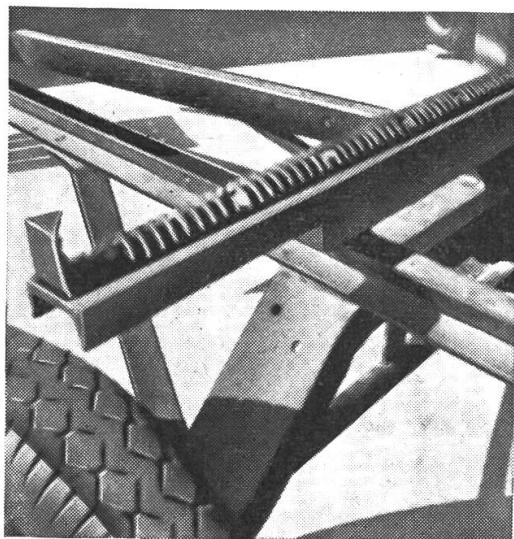
Anhänger auch für Holztransporte auf der sehr steilen, unwegsamen Alp, wo mit einem grösseren Wagen überhaupt nicht gefahren werden kann. Ausgediente Dreschmaschinen - Schlagleisten (Abb. 2) verhindern das Rutschen jeder Holzladung. Sie können gut mit Schrauben befestigt werden. Sie bewähren sich auch auf jedem andern Holzwagen oder Schlitten.
