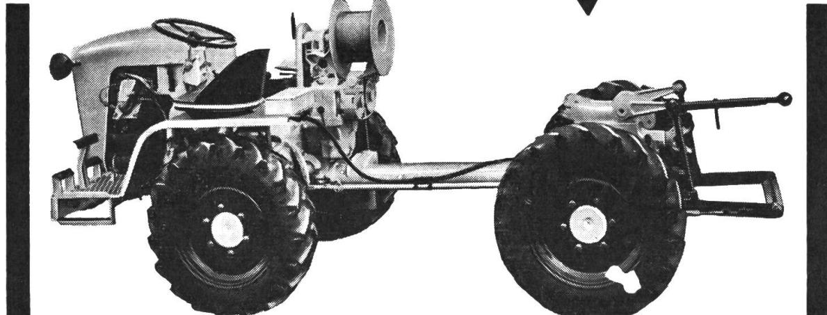
Jedes bekannte Gerät lässt sich anbauen: z.B. Front-Mähbalken, Rotoregge, Baumspritze etc. Mit langgestelltem Radstand und Brücke — das fantastische Geländefahrzeug.
