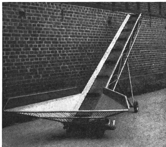
«Firo»-Förderband für Kartoffeln und Rüben mit 1,80 m breitem Einwurftrichter zum Aufstellen hinter dem Stallungstreuer.
