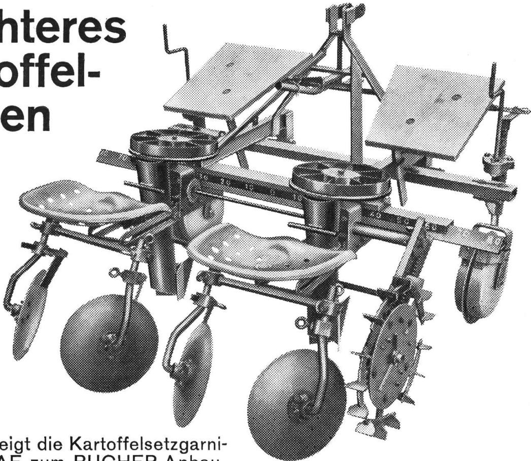
Das Bild zeigt die Kartoffelsetzgarnitur Pos. 1 AE zum BUCHER-Anbauvielfachgerät. Sie kann für das zwei-, drei- oder vierreihige Setzen zusammengestellt werden und zwar mit Scharen oder Scheiben zum Zudecken. Die Bedienungsleute auf dem Gerät legen die Kartoffeln ganz einfach in die Zellen der angetriebenen Zellenräder, die dafür sorgen, dass sie in gleichmässigen Abständen in die Legeröhren geführt werden. So ist die Arbeit weniger ermüdend.
