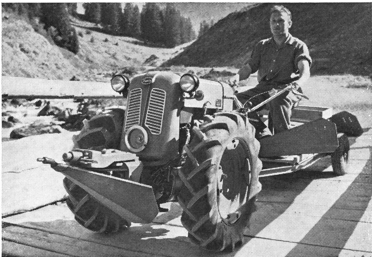
Mit aufgedrehtem Mähausleger fahren erhöht Zugleistung und Strassenhaltung
