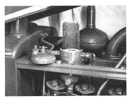
Ausbau und Reinigung des Treibstoff-Hauptfilters
