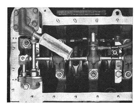
Das Sieb der Oelpumpe soll nach etwa 300 Betriebsstunden mit der Oelwanne gereinigt werden
