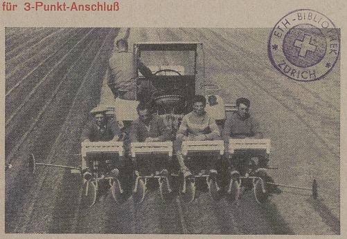
Kartoffelsetzen 4-reihig mit unseren pat. Setzautomaten. Hangsteuerung beim Setzen möglich.
