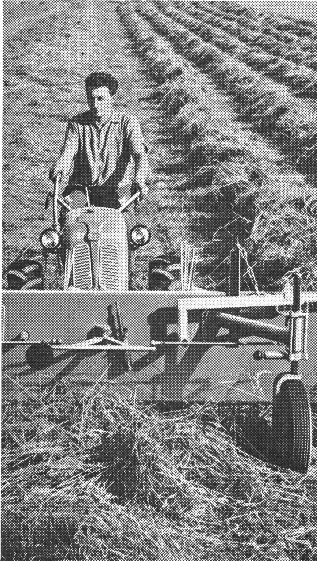
voran angeschlossene Anbaugeräte wie Mähapparat, Heuknecht, Frontbinder
