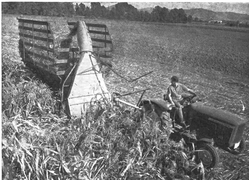
Schlegelfeldhäcksler John-Deere-Lanz» im Einsatz.
