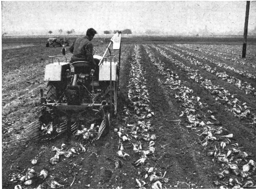
Der neue Vorratsroder «Aebi» mit vorgeschal- teter 3-reihiger Rüben- hebevorrichtung. Die Rüben werden in einer Reihe abgelegt.
