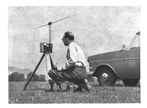
Abb. 3: Kontrolle des Störvermögens eines Motorfahrzeuges mit dem Feldstärke-Messgerät.
