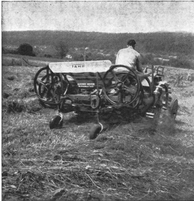
◀ Abb. 1: Traktor mit aufgesatteltem Bandrechen beim Zetten von Schwaden
