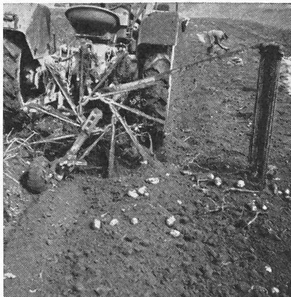
Schleuderradgraber mit Fangrechen und Fangkorb
