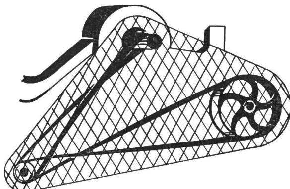
An Dreschmaschinen werden drehende Wellen und Riemenscheiben gegen jegliches Berühren genügend abgedeckt.
