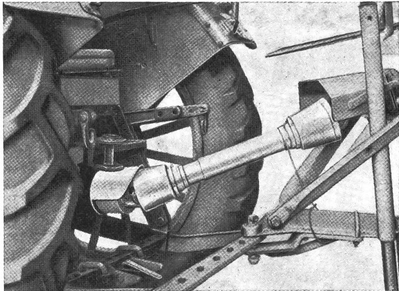
An Fahrzeugen und Maschinen sind Zapfwellen, Gelenkwellen und andere bewegliche Teile zweckmäßig gegen jedes Berühren zu schützen.
