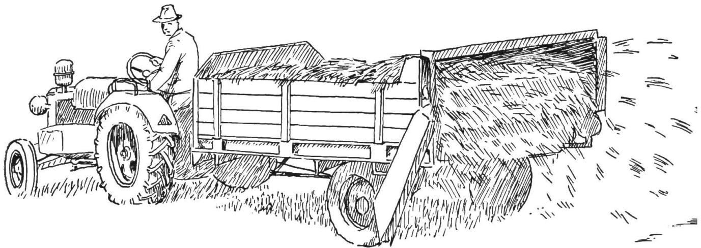
Solange die Mistzettmaschine in Betrieb ist, sollen auf ihr keine Personen geduldet werden. Vor dem Beheben von allfälligen Störungen stelle man Maschine und Traktor ab.
