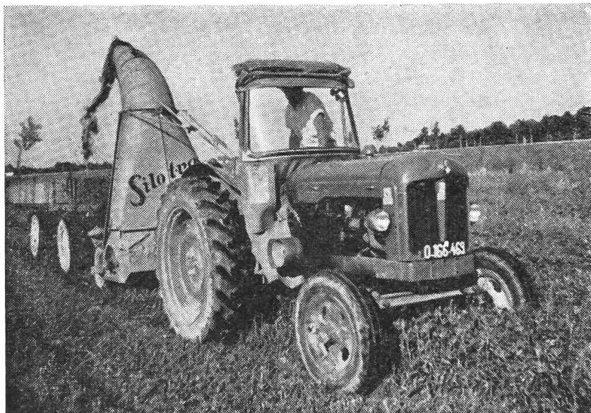
Abb. 2: Direkt hinter den Schlepper angehängter Schlegelfeldhäcksler
