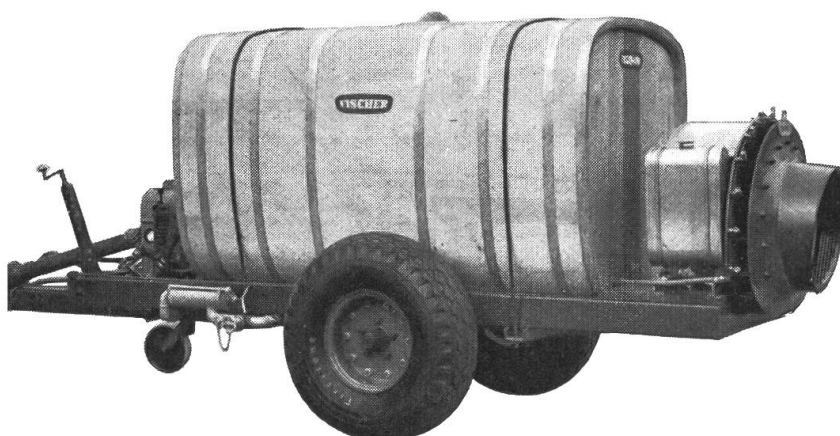
Anbau-Motorspritze mit fächerförmigem Verteilstück
