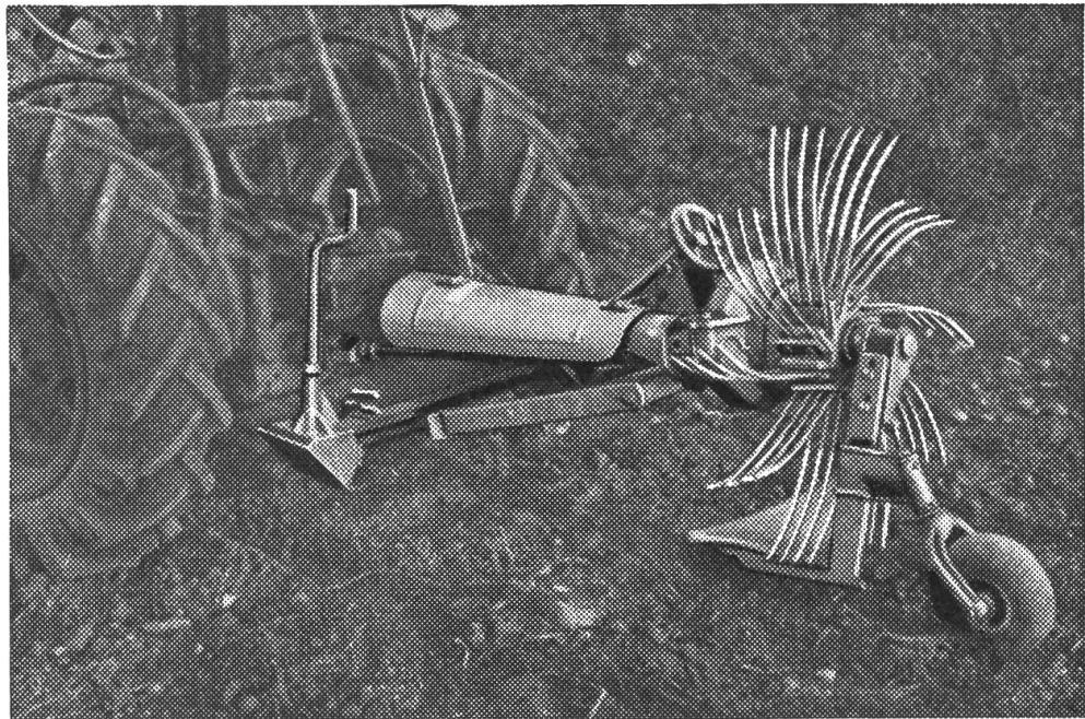
seitlich und in der Höhe vom Sitz aus verstellbar. Antrieb im Oelbad auf Kugellager laufend. Für alle Traktoren mit zentraler Zapfwelle, mit und ohne Hydraulik. Kombinierbar als Rübengraber.
