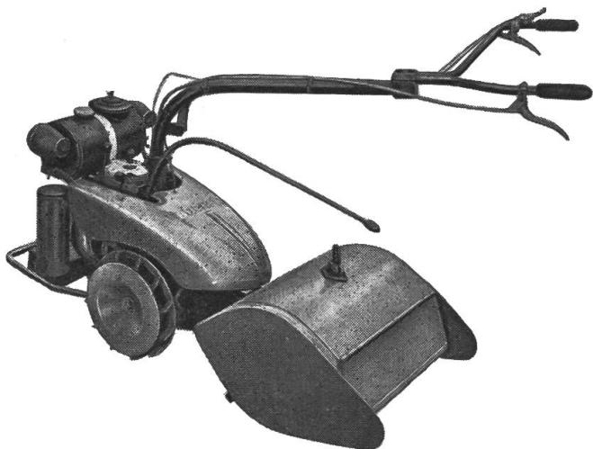
Der BUCHER K 4, eine Universalmaschine für Acker-, Zug- und Erntearbeiten. Zusatzgeräte: Mähwerk, Eingrasvorrichtung, Getreideablage, Motorheuer, Zapfwellenwagen usw.
