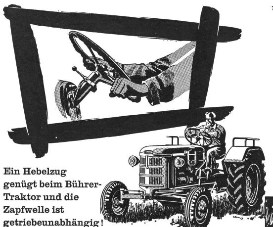
Die getriebeunabhängige Zapfwelle (auch Motor-Zapfwelle genannt) ist heute an einem modernen Traktor eine unbedingte Notwendigkeit. Denn nur mit ihr ist der einwandfreie Antrieb einer Reihe neuzeitlicher, arbeitsparender Erntemaschinen gewährleistet.
