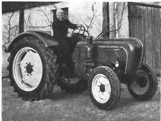
Abb. 2: Der neue Porsche-Diesel Super L mit 3-Zylinder luftgekühltem Motor, 40 PS, 8 Vorwärts- und 4 Rückwärtsgängen, Motorzapfwelle hinten und vorn, hinten umschaltbar von 540 auf 1100 Touren, ausserdem umschaltbar auf Wegzapfwelle, Doppelkupplung, neuartigem Beifahrersitz in Fahrtrichtung zwischen den Kotflügeln.
