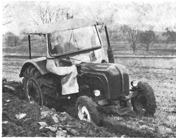
Abb. 1: Porsche-Diesel-Master, 50 PS, mit Bereifung 13-20, bei schwerem Rigol-Pflügen.
