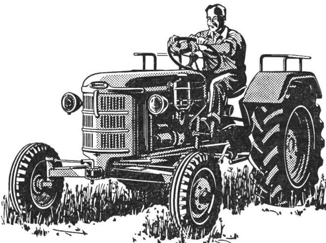
Im Gefälle, wo mittels des Motors gebremst wird und eine schwere Last «von hinten stösst», ist das Schalten in den nächst tieferen Gang mit einem gewöhnlichen Traktor oft sehr gefährlich. Ganz anders beim «Bührer» mit dem einzigartigen Triplex-Getriebe, das erlaubt, ohne auszukuppeln, nur durch Umlegen des Triplex-Hebels auf den nächst niedrigeren Gang zu schalten und so absolut gefahrlos die Fahrgeschwindigkeit zu reduzieren.
