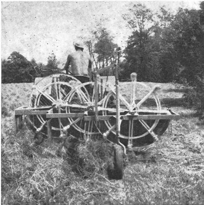
Abb. 7: Rechenrad-Heuerntemaschine beim Erstellen von Zettschwaden
