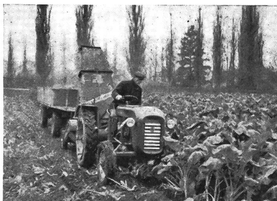
Abb. 8: Mähen und Laden von Markstammkohl mit Schlegelfeldhäcksler
