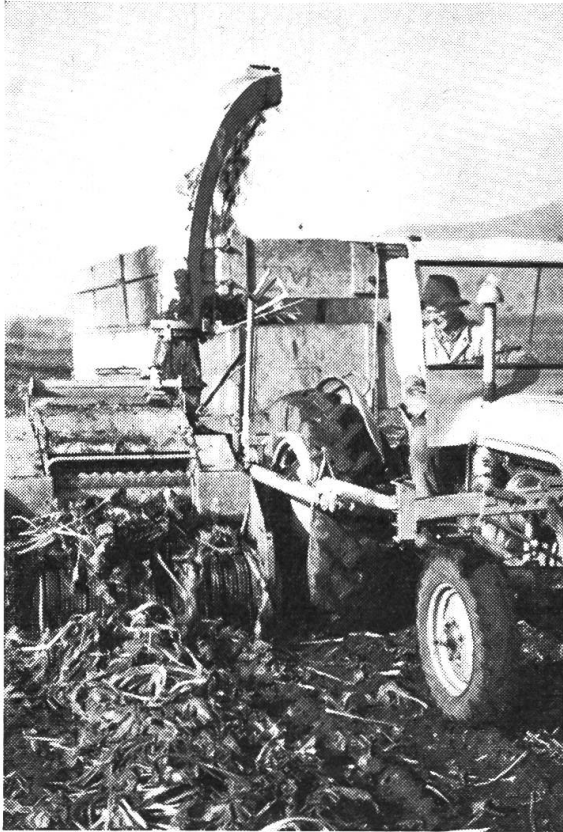
Abb. 10: Ernte von Zuckerrübenlaub mit Schneidefeldhäcksler
