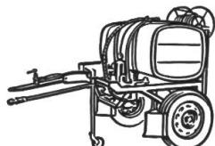
Bimoto-TITAN BH-II, aufgebaut auf Zweiradwagen mit 800 Liter-Holzfass — Rühr-Injektor — grosser Saug-filter — Druckleitungsfilter — Schnellschlussahn — 13-reihiger Spritzbarren — Spritzausstattung mit 15 m Hochdruckschlauch und Spritzrohr 45 cm — Kardanwelle
