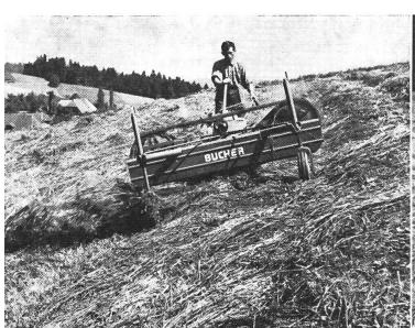
Abb. 2: Kettenrechen mit 2 Stützrädern (Motorheuer Bucher)
