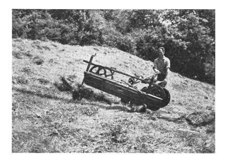
Abb. 4: Zetten bei starker Schrägstellung des Rechens
