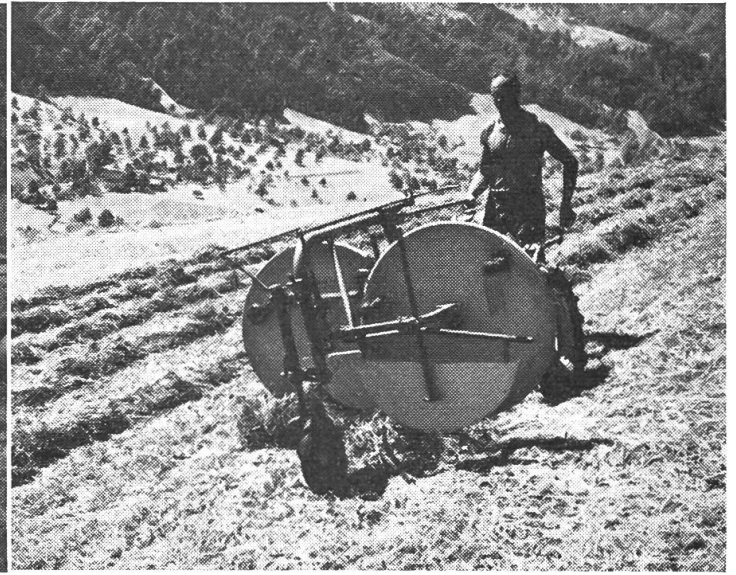
Abb. 1a und 1b: Schrägtrommelrechen mit einem bzw. zwei Stützrädern (Aebi-Heuer)
