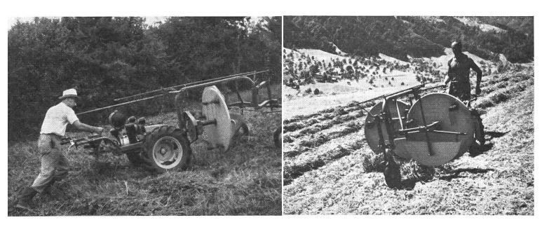
Abb. 1a und 1b: Schrägtrommelrechen mit einem bzw. zwei Stützrädern (Aebi-Heuer)
