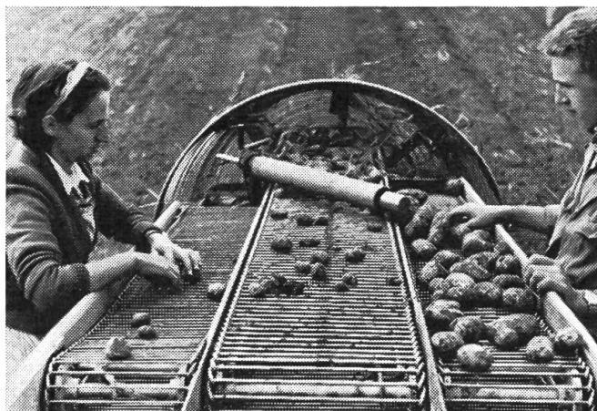
In der Frühernte oder bei anormalen Verhältnissen wird die Sortierwalze entfernt. In diesem Falle können die Kartoffeln direkt von beiden Seiten ab dem Zuliefererband in die äusseren, zur Absackung führenden Verlesebänder hinüber verlesen werden. Diese Methode erlaubt, Frühkartoffeln direkt ab SAMRO, marktfertig in den Verkauf zu bringen.
