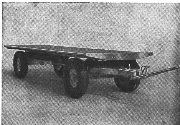
«WM»-Pneuwagen, 1,5–5 Tonnen Nutzlast, rostfreie Ganzmetallkonstruktion. Sehen Sie sich den modernsten aller Pneuwagen, den «WM»-Super persönlich an!
